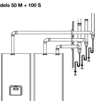
安装独立Φ50mm排烟管道时，各管之间的最小安装间距。
