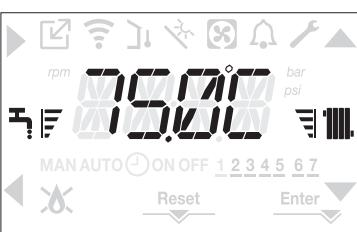
此时，锅炉显示采暖出水温度。使用热水时，显示热水出水温度。
