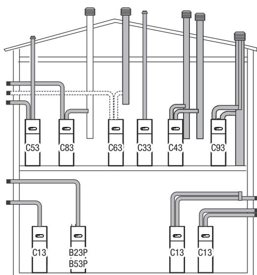
**B23P** - Ventilatore a monte. Aspirazione aria comburente direttamente dal locale dov'è installata la caldaia. Scarico gas combustivi a mezzo di condotti orizzontali o verticali progettati per operare ad una pressione positiva, e predisposte prese di ventilazione.
