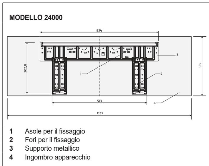
**⚠** Posizionare il supporto metallico su una superficie livellata ed in grado di sostenerne il peso
