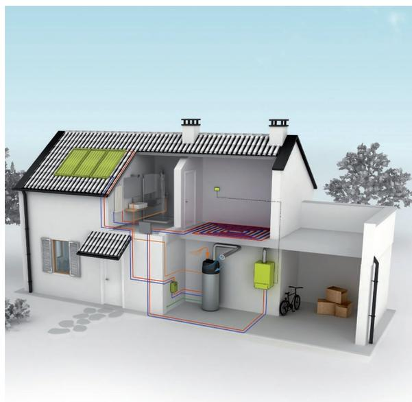
Fig. 2 **HP-E 260 ACS S**: integrazione con solare termico
