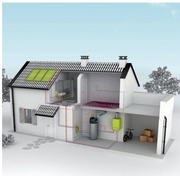
Fig. 4 **HP-E 260 ACS SC**: integrazione con solare termico e caldaia
