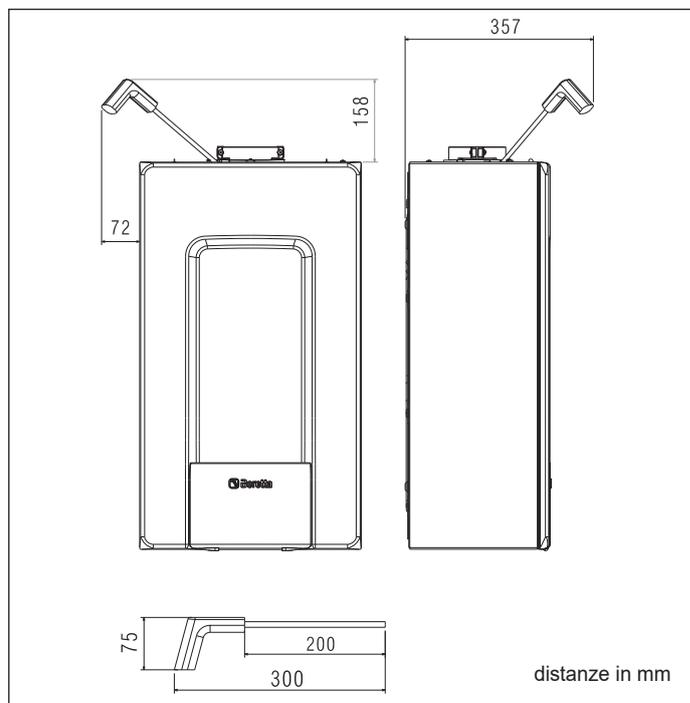
⚠ In caso di installazione è **INDISPENSABILE** prevedere gli spazi necessari per l'introduzione dello strumento per l'analisi combustione. Riportiamo un disegno campione dove le distanze tra caldaia e pensile/nicchia sono state ottenute utilizzando uno strumento di lunghezza 300 mm. Strumenti di lunghezze superiori necessitano di spazi maggiori.
