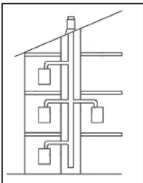
La caldaia è dimensionata per funzionare correttamente fino ad una pressione massima interna della canna fumaria non superiore al valore di 25 Pa.
