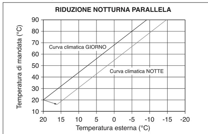
L'utente può indirettamente intervenire sul valore di setpoint RISCALDAMENTO andando ancora una volta ad introdurre, sul valore di temperatura di riferimento GIORNO (20°C) piuttosto che NOTTE (16°C), un offset che può variare all'interno del range [-5 ÷ +5]. Per la correzione dell'offset fare riferimento la paragrafo "4.8 Regolazione della temperatura acqua di riscaldamento con sonda esterna collegata".
