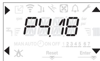
La termoregolazione funziona solo con sonda esterna collegata ed è attiva solo per la funzione RISCALDAMENTO. Se P4.18 = 0 o sonda esterna scollegata, la caldaia lavora a punto fisso. Il valore di temperatura rilevato dalla sonda esterna viene visualizzato nel menu INFO "4.20 Menu INFO" alla voce I0.09.
