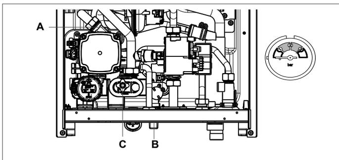
NOTA: le operazioni di riempimento dell'impianto devono essere fatte agendo sul rubinetto di riempimento (B) con caldaia in stato OFF.
