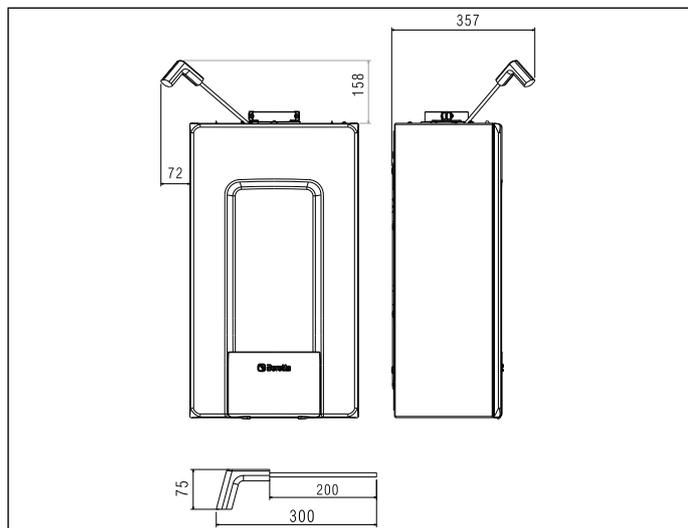
**!** In caso di installazione è **INDISPENSABILE** prevedere gli spazi necessari per l'introduzione dello strumento per l'analisi combustione.
