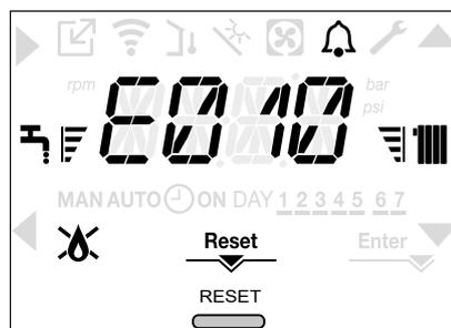
Se i tentativi di sblocco non dovessero riattivare la caldaia, interpellare il Servizio Tecnico di Assistenza di zona.
