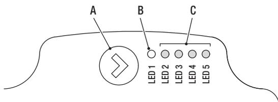
L'interfaccia utente permette di visualizzare le prestazioni in funzionamento (stato funzionamento e stato allarme) e impostare le modalità di funzionamento del circolatore.
