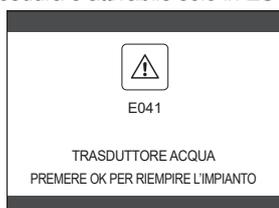
Durante la fase di caricamento sul display compare il messaggio scorrevole a piè di pagina "RIEMPIMENTO SEMIAUTOMATICO IN CORSO", il valore di pressione evidenziato sul display dovrebbe iniziare a salire. Alla fine del caricamento il messaggio scorrevole "TERMINATO RIEMPIMENTO SEMIAUTOMATICO" viene visualizzato a piè di pagina.
