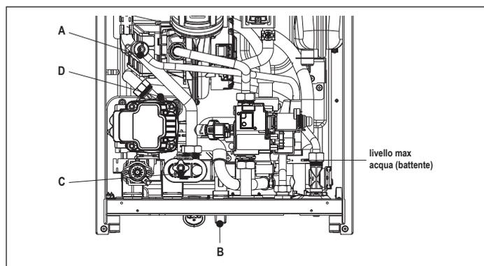
NOTA: anche se la caldaia è provvista di un dispositivo di riempimento semiautomatico, la prima operazione di riempimento dell'impianto deve essere fatta agendo sul rubinetto di riempimento (B) con caldaia in stato OFF.
