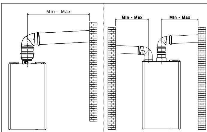
È possibile installare le curve e le prolunghie, disponibili come accessori, in base al tipo di installazione desiderato. Le lunghezze massime consentite del condotto fumi e del condotto aspirazione aria sono riportate nel capitolo "3.8 Scarico fumi ed aspirazione aria comburente".
