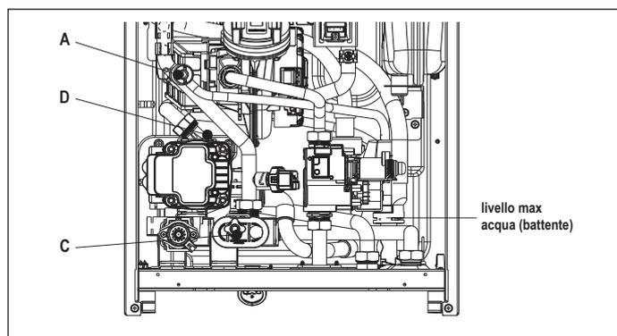
NOTA: anche se la caldaia è provvista di un dispositivo di riempimento semiautomatico, la prima operazione di riempimento dell'impianto deve essere fatta agendo sul rubinetto di riempimento (**esterno alla caldaia**) con caldaia in stato OFF.
