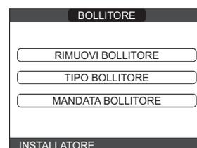
**TIPO BOLLITORE:** il parametro permette di impostare il tipo di bollitore sanitario. Impostare il valore a 1 per selezionare un bollitore con sonda, impostare il valore a 0 per selezionare un bollitore con termostato (valore impostato da fabbrica).
