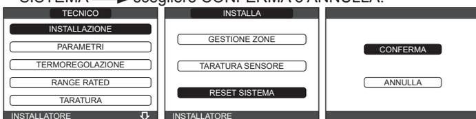
NOTA: Dopo un'operazione di reset è necessario eseguire una nuova configurazione del sistema; per i dettagli relativi a questa procedura fare riferimento al paragrafo seguente.
