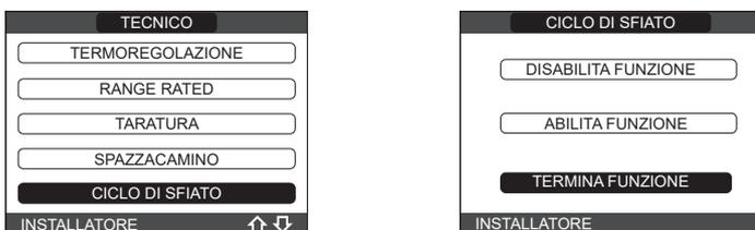
Il REC10CH visualizzerà per un attimo un messaggio di attesa dopo di che si riporterà automaticamente sulla schermata principale. Il ciclo di sfiato può essere anche interrotto, se caldaia non in OFF, da una richiesta di calore sanitario.
