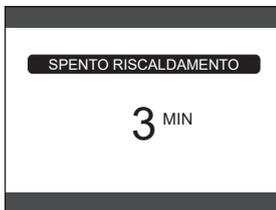
**AZZERA TEMPI RISC:** questo parametro consente di azzerare la TEMPORIZZAZIONE POTENZA MASSIMO RISCALDAMENTO RIDOTTA, durante la quale la velocità del ventilatore risulta limitata al 75% della massima potenza riscaldamento impostata, e la TEMPORIZZAZIONE SPENTO FORZATO RISCALDAMENTO. Il valore di fabbrica è FUNZIONE NON ATTIVA, scegliere FUNZIONE ATTIVA e confermare la scelta per azzerare le temporizzazioni.
