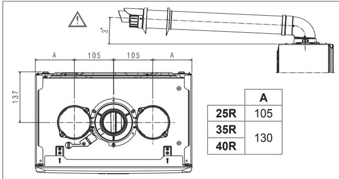
⚠ La lunghezza rettilinea si intende comprensiva della prima curva (connessione in caldaia), di terminali e giunzioni. Viene fatta eccezione per condotto coassiale Ø 60-100 mm verticale, la cui lunghezza rettilinea si intende senza curve.
