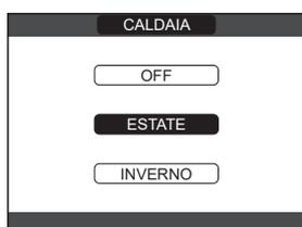
**INVERNO** / : selezionando nel menù STATO → CALDAIA → INVERNO si attivano le funzioni di riscaldamento e acqua calda sanitaria. Sul REC10CH viene normalmente visualizzata la temperatura dell'acqua sanitaria (se bollitore con sonda collegato), in assenza di un bollitore oppure se collegato un bollitore con termostato oppure in corso una richiesta di riscaldamento, viene visualizzata la temperatura di mandata della caldaia.
