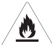
Risco de incêndio/ materiais inflamáveis
