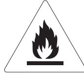
Risque d'incendie/ matières inflammables
