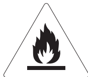
Riesgo de incendio/ materiales inflamables
