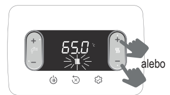
druhé stlačenie nastavenie nastavovacej hodnoty vykurovania, s rozstupom 0,5°C
