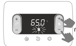
δύετη πίεση ρύθμισης τιμής του setpoint θέρμανσης, με διαβαθμίσεις 0,5 °C
