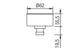
Kit chiusura raccordo a "T" per scarico condensa
