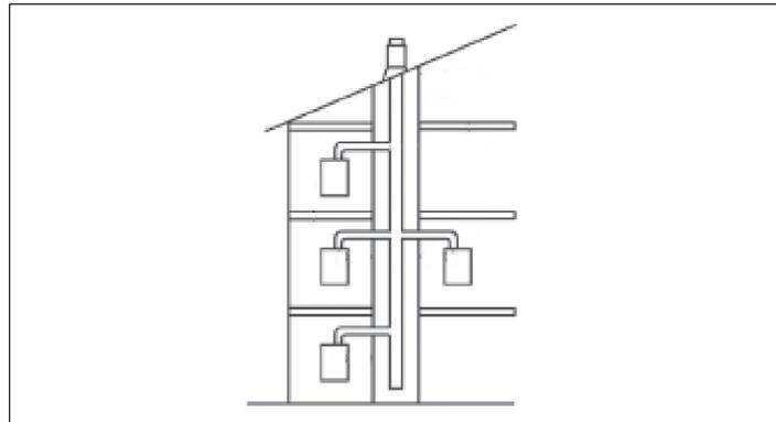
Le canne fumarie collettive in pressione positiva possono essere utilizzate soltanto per apparecchi a condensazione di tipo C. Di conseguenza la configurazione B53P/B23P è vietata. L'installazione delle caldaie su canne fumarie collettive in pressione è permessa esclusivamente a G20.
