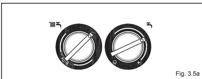
Per disattivare la funzione preriscaldamento ruotare nuovamente la manopola regolazione temperatura acqua sanitaria sul simbolo ☺. Il led giallo si spegne. Riportare la manopola di regolazione temperatura acqua sanitaria nella posizione desiderata.
